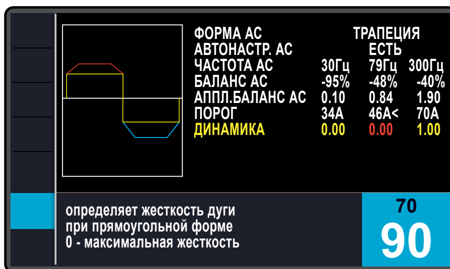
Рис. 34 – Экран настройки переменного тока
